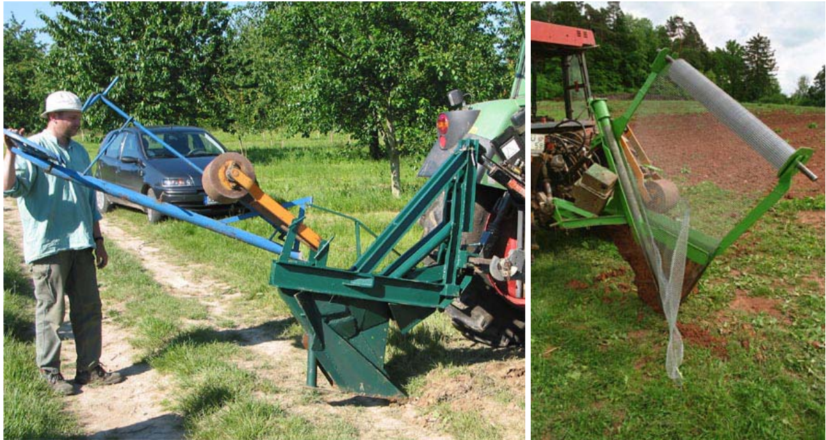
Abb. 2: Grabenpflug (links) und Verlegegerät (rechts) zur 50 cm tiefen Installation von Migrationsbarrieren aus Casanet-Drahtgitter.
