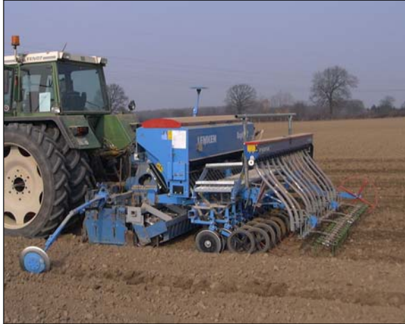
Abb. 6: Drillmaschine (24 Reihen) mit einem Nachsaatkasten mit 12 fixierten Ausläufe für eine Breitsaat vor dem Striegel oder eine Saat in alternierenden Reihen durch Umstecken der Schläuche an die Drillschare, Trenthorst 2003
