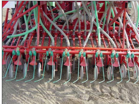
Abb. 11: Umsteckmöglichkeiten von Säschläuchen an verschiedene Säaggregate einer Parzellendrillmaschine, Trenthorst 2003
