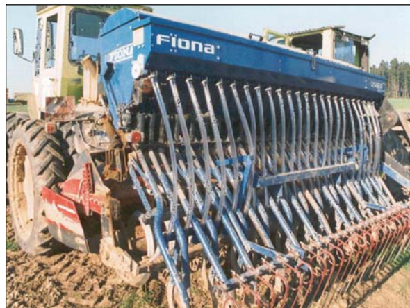
Abb. 5: Standard-Drillmaschine (3m, 24 Reihen) mit Nachsaatkästen und 24 flexiblen Auslaufschläuchen, Pfaffenhofen 2003
