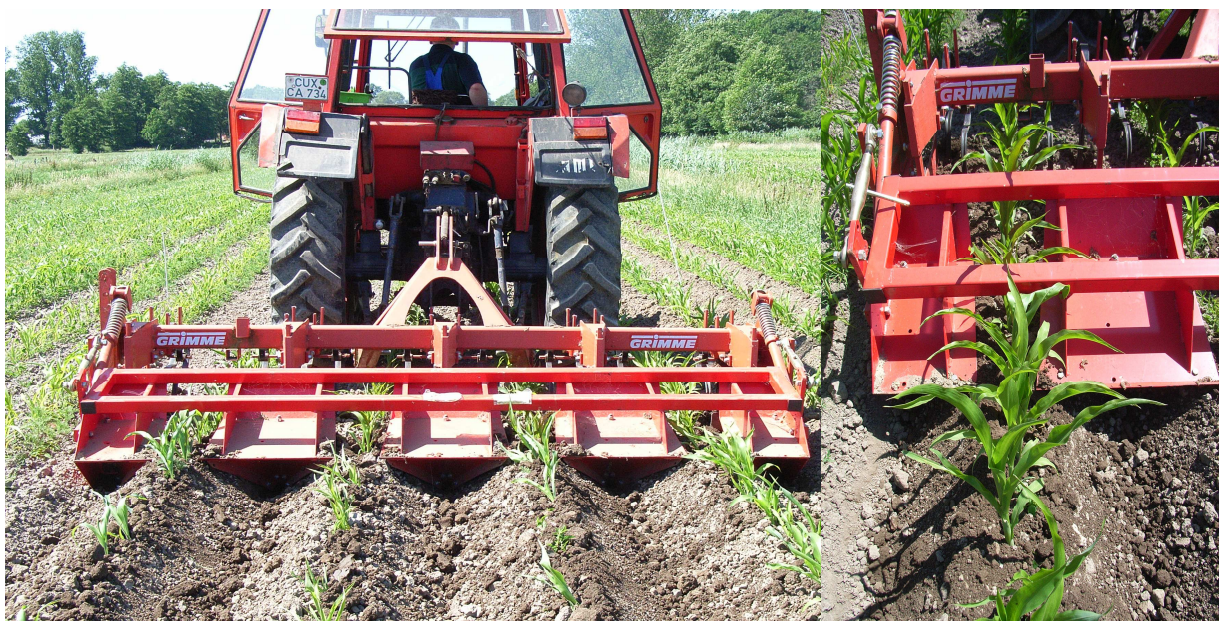
Abb. 8: Häufelgerät mit geteiltem Dammformblech für wachsende Bestände
