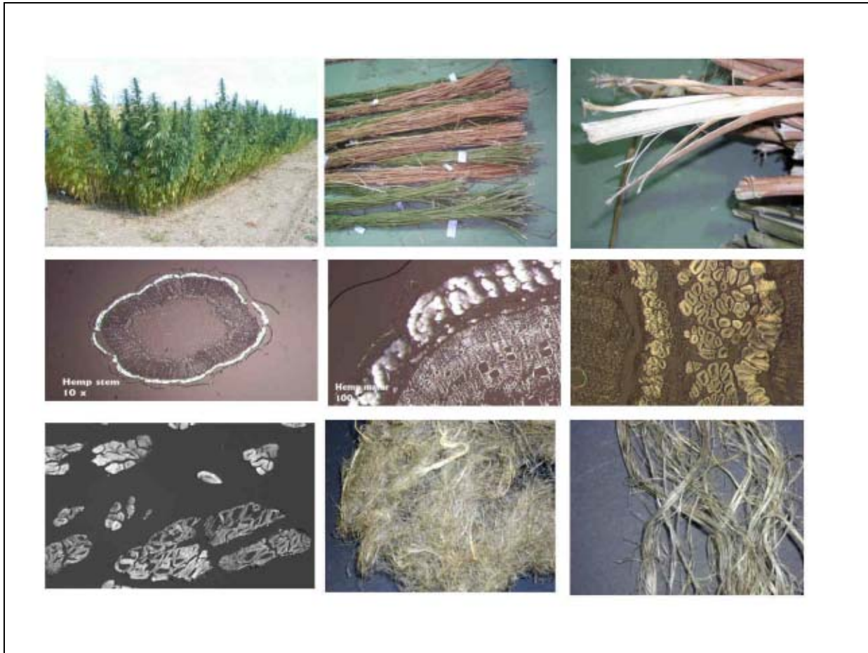
Abb. 1: Hanfstängel (1, 2) , Bastanteil (3) , Mikroskop. Querschnitt Hanfstängel (4-7), entholzte Bastfasern (8,9)
