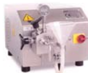
Niro Soavi Lab. Homogenisator NS1001L2K 10/1h - 1.500 bar
