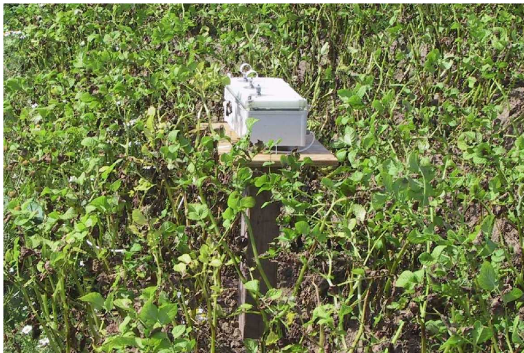
Figur 1. Sporefælde anvendt til fangst af sporangier af Phytophthora infestans ved Flakkebjerg 2002. Spore trap used to catch sporangia of Phytophthora infestans at Flakkebjerg 2002.
